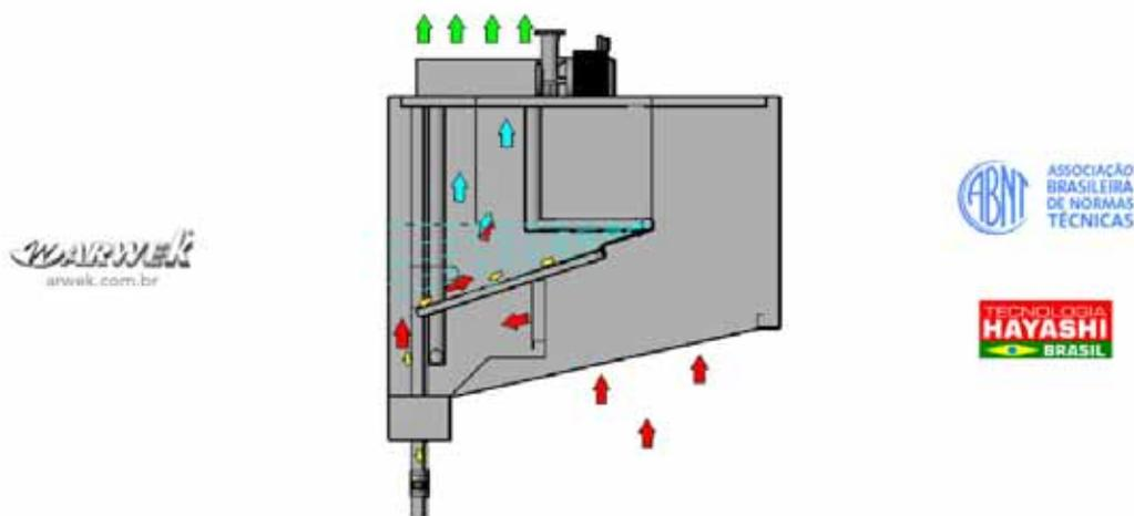
Sempre pensamos em inovações e soluções sustentáveis por conta disso desenvolvemos um novo sistema no conceito de coifa lavador com hidro filtro tipo "PASS THROUGH" maximizando a eficiência do equipamento e minimizando a manutenção e com um novo sistema de prevenção de entupimento dos bicos aspersores. Seu funcionamento automatizado sem contato manual permite maior eficiência durante o processo de lavagem do ar da exaustão. Desta forma, a economia de energia, água e detergente são maiores,
