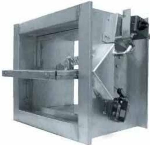
Os dampers corta fogo servem para isolar determinadas zonas contra propagação do fogo em instalações de exaustão e ar-condicionado, além de redes de dutos também pode ser montados em paredes, lajes e o mesmo poderá ser acionado por fusível térmico, solenoides, motor elétrico, pistão pneumático etc.
