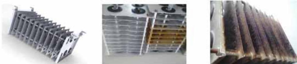
Os módulos eletrostáticos são constituído de um grupo de laminas (positiva e negativa) de material nobre que ao energizar libera trilhões de ions negativos, atuando na quebra das moléculas de gordura as polarizando, e por meio do princípio da estática e da atração de cargas eletricamente opostas os particulados graxos são atraídos para as
