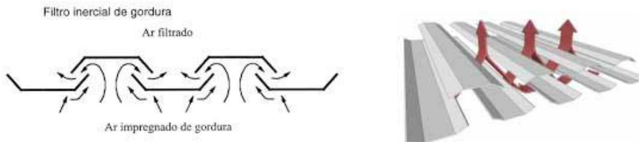
Nota: Os inerciais auxiliam o sistema de combate a incêndio pois proporcionam um efeito corta-chama. A inclinação dos filtros deverá ser o mais próximo possível dos 45° para seu correto funcionamento.
